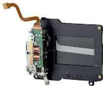
Slika 7. Primjer fokalnog zatvarača digitalnih fotoaparata
